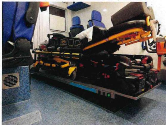
Für den Patienten bietet die Kombination aus Fahrzeug, Trage und Hoverboard einen hohen Komfort. Die vollautomatische Luftfederung des Hoverboards stellt sich automatisch auf das Gewicht des Patienten ein und hilft mit, die Fahrbahnunebenheiten zu absorbieren. Da der Patient mit Hoverboard 30 cm höher liegt, können der Notarzt sowie auch das Rettungsdienstpersonal den Patienten in aufrechter Position behandeln.
