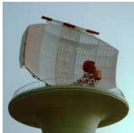
Radaranlagen zur Luftraumüberwachung arbeiten mit hohen Sendeleistungen.
