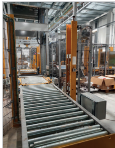
Teil der neuen Verpackungsstraße mit automatisiertem Palettierer und Etikettierer
